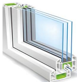
Una aplicación práctica de este fenómeno es el uso de **paneles de vidrio separados por aire** para reducir la pérdida de calor. Este diseño es más eficiente que simplemente aumentar el grosor del vidrio, ya que la **conductividad térmica** del aire es mucho menor que la del vidrio. Por lo tanto, la capa de aire entre los paneles actúa como un aislante térmico eficaz.
